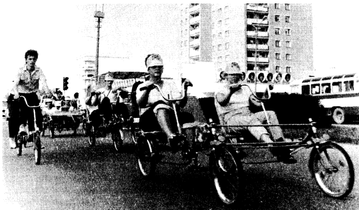
Рис. 9.7. Простейшая конструкция четырехколесного веломобиля «Наташа» с детским сиденьем
